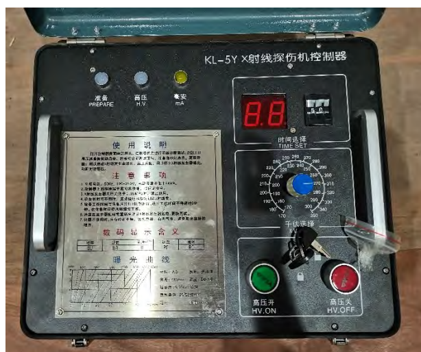
X 射线探伤机控制端出束状态指示灯
